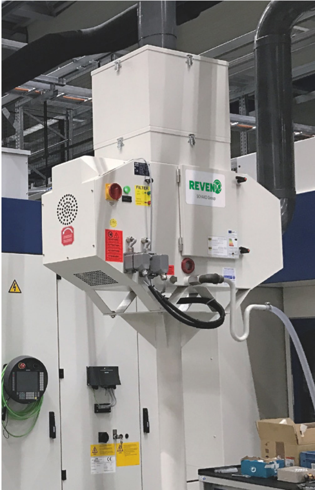
Beispiele für Industrie-Luftreiniger: X-CYCLONE® C (Kompakter Luftreiniger mit zusätzlichem Schwebstofffilteraufsatz), X-CYCLONE® CE (Elektrostatischer Luftreiniger), X-CYCLONE® RJ (kleiner kompakter Luftreiniger)
