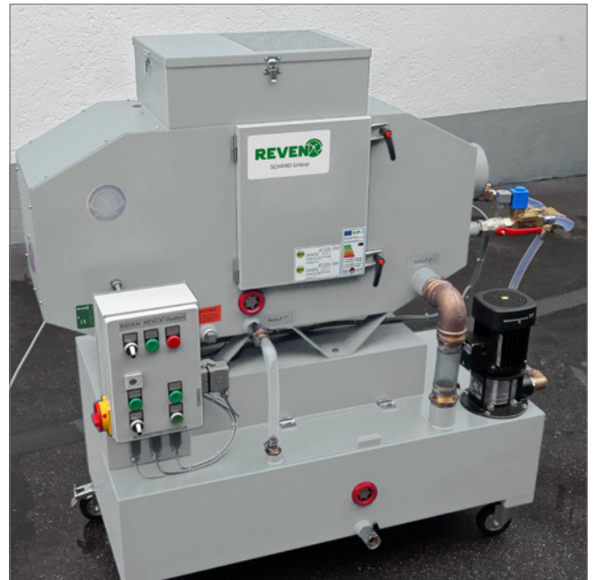
Abb.: Anschlussbeispiel des REVEX® Sprühsystems mit Steuerung (links) und Pumpe (rechts)
