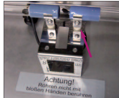
Abb.: Klemmbügel mit Spannschraube und Rändelmutter
