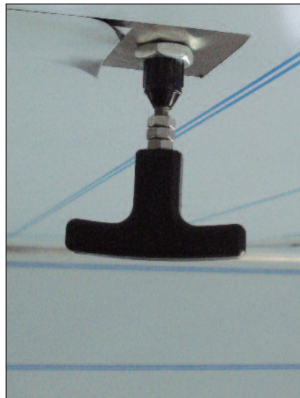
Abb.: Feststellhebel oben Fig.: adjusting lever in the upper position
