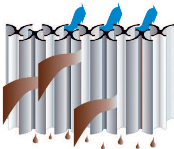
Abb.: effektive Abscheidung von Ölen, Wrasen und sonstigen Flüssigkeitsnebeln (Aerosole). Fig.: effective separation of oils, fumes and other fluid mists (aerosols).
