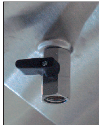
Abb.: Kugelventil mit Teflonsitz
